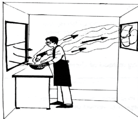
M나쁜 환기: 열린 창문에서 들어온 바깥 공기가 화학물질을 근로자의 얼굴로 바람불도록 한 후 살롱 실내 바깥으로 빠지게 하는 환기.
