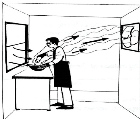
Thông gió không đúng cách: Không khí bên ngoài từ cửa sổ mở ra thổi các hóa chất vào mặt của người thợ trước khi thoát ra khỏi tiệm.
